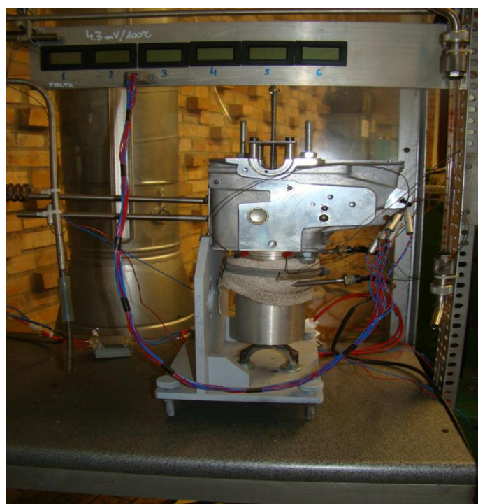
Фиг. 2. Изглед на прототипа с вътрешен катализатор
