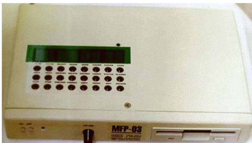
Фиг. 6. Устройство за запис, редактиране и възпроизвеждане на MIDI-файлове „MFP-03“ в действие (текущо темпо при възпроизвеждане: ♩ = 193)
